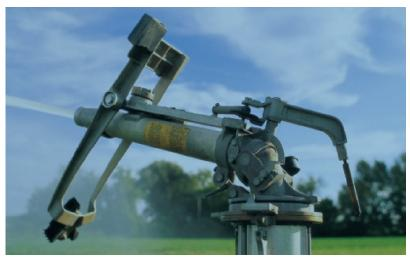
o Cañones.-Los cañones funcionan de la misma manera que los rotores; sin embargo se trata de componentes mecánicos de mayores dimensiones que los rotores, por lo que estos se encuentran normalmente fijados sobre mástiles elevados y aún que su aspecto es poco estético, su poder les permite alcanzar radios superiores a los 30 mts. Este tipo de aspersores manejan muy altas presiones por lo que su uso debe ser diseñado como siempre por un especialista en sistemas de riego.
